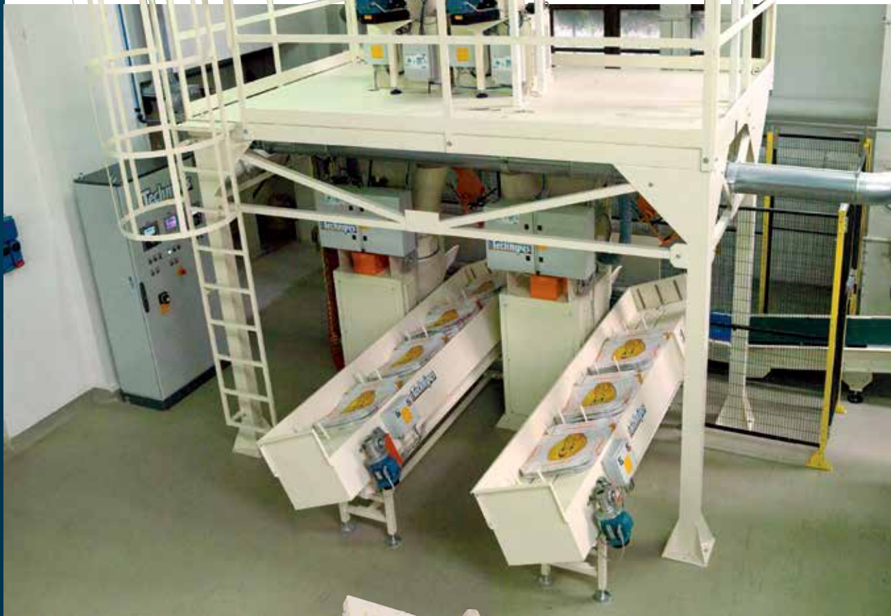
Stazione d'insacco a tre bocche installato presso Mulino sul Clitunno (Italia) Three-spout bagging station installed at Mulino sul Clitunno (Italia) Station d'ensachage à trois bouches installée près de Mulino Giambastiani (Italie)
